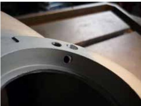
Jetzt muss die alte schräge Bohrung verschlossen werden.
