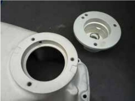
Kupplungsdeckel demontieren und reinigen
