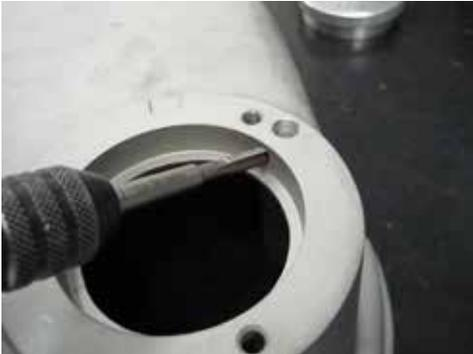
Dazu einen dreiteiligen Gewindebohrersatz M6 verwenden - und das Gewinde nur mit dem 1. und 2. Gang schneiden.
