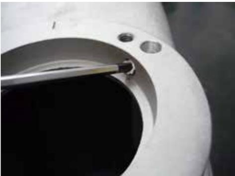
Die mitgelieferte schräg geschnittene Madenschraube so eindrehen, dass sie die Bohrung verschliesst und die Schräge möglichst genau mit der inneren Kante abschliesst. LOCTITE Endfest verwenden!
