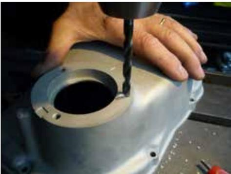
Ölfiltergehäuse entfernen und weiterbohren, bis der darunterliegende Ölkanal geöffnet ist
